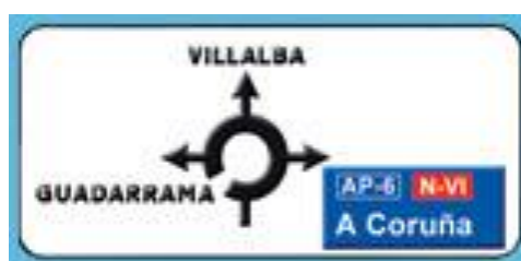
S-200. Preseñalización de glorieta
